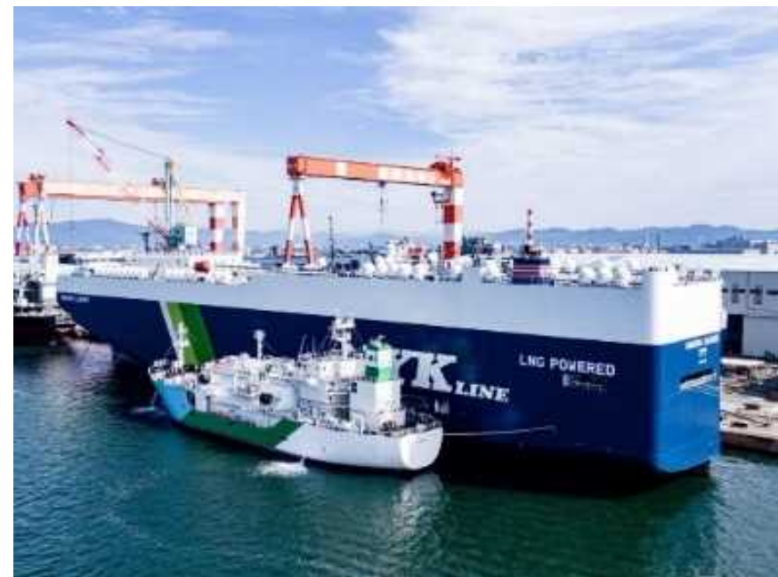
LNGバンカリングの様子（出典：Central LNG）
