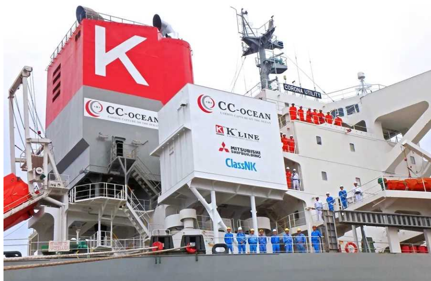
三菱造船、川崎汽船及び日本海事協会によるプロジェクト (本船への搭載が完了したCO2回収装置の様子)
