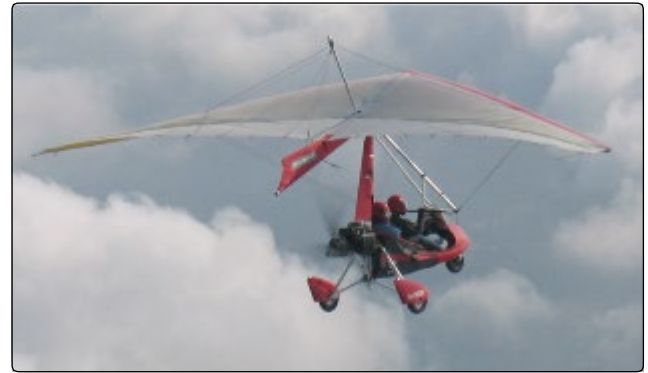
図3-9. 重量シフト制御航空機は、制御のために重量の移行を使用する。
