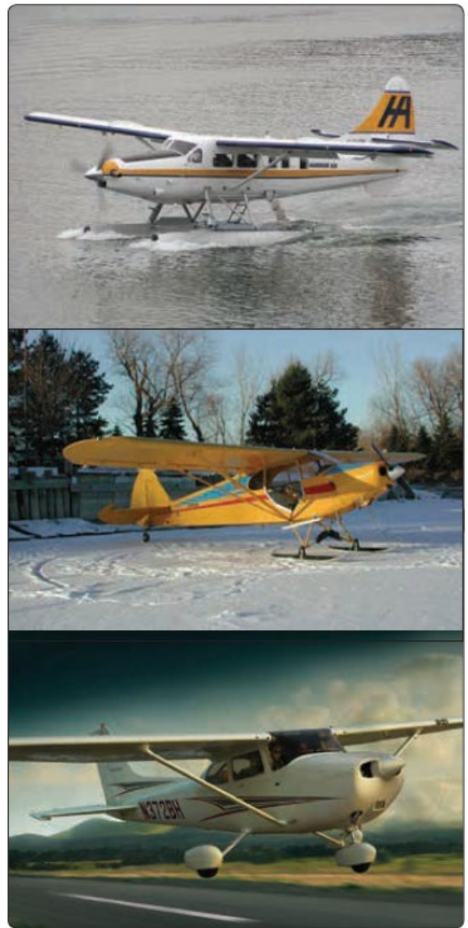
図3-12. 着陸装置の種類：フロート（上）、スキー（中央）、車輪（下）
