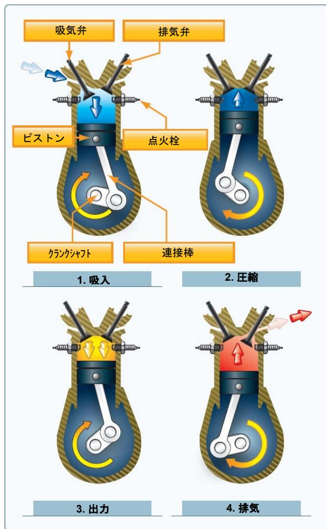
図 7-5. この図の矢印は、4ストロークサイクル中のクランクシャフトとピストンの動きの方向を示している。
