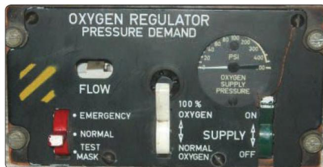
図 7-43. 酸素システム制御器
