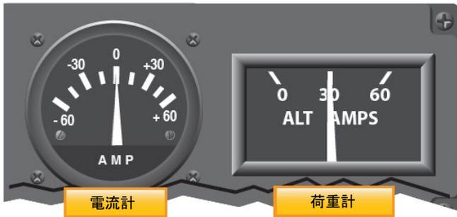
図 7-35. 電流計と荷重計
