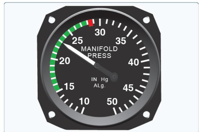
図 7-9. エンジン出力は、マニホールド圧力計に表示される。
