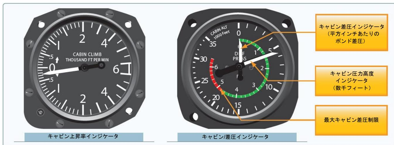
図7-42. キャビン加圧計器
