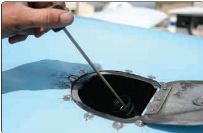
図7-18. 飛行前の点検中は、必ずエンジンオイルのレベルを確認する。
