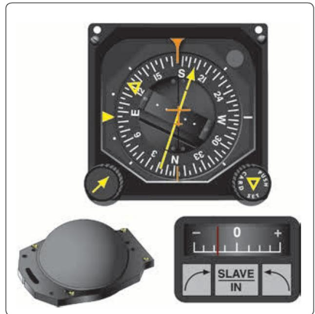
図 8-29. 画像ナビゲーションインジケータ (HSI、上部)、スレービングメーター (右下)、およびスレーブ制御補正ユニット (左下)。
