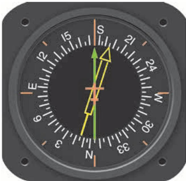
図 8-30. フラックスバルブからの信号によって駆動されるこのRMIのコンパスカードは、上部中央インデックスマークの反対側の航空機の機首方位を示す。緑のポインターはADFによって駆動される。
