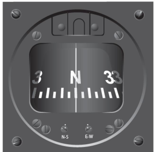
図 8-32. 磁気コンパス。垂直線は、ラバーラインと呼ばれる。
