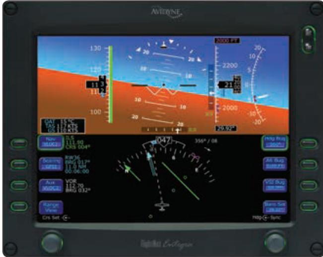
図 8-14. Chelton's FlightLogic (上) と Avidyne Entegra (下) は、構成可能なパネル表示の例である。
