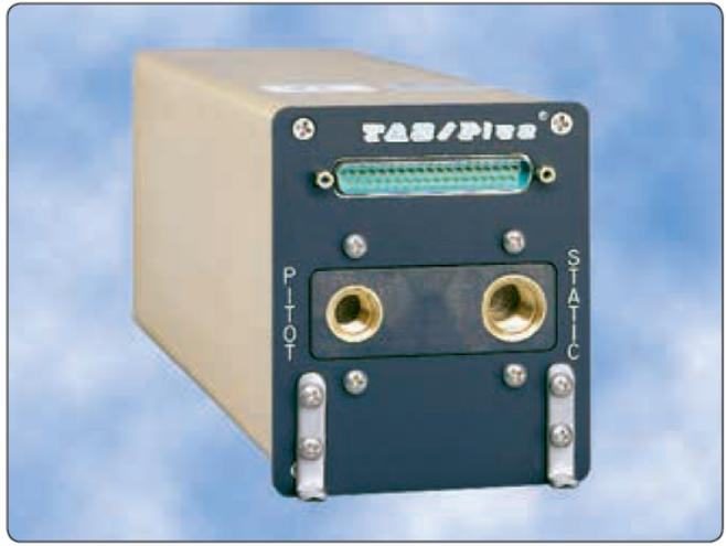
図 8-15. Teledyne's 90004 TAS/Plus Air Data Computer (ADC) は、ピトー静圧空気システム、航空機温度プローブ、気圧補正デバイスからの空気データ情報を計算して、飛行特性の明確な画像を作成する。
