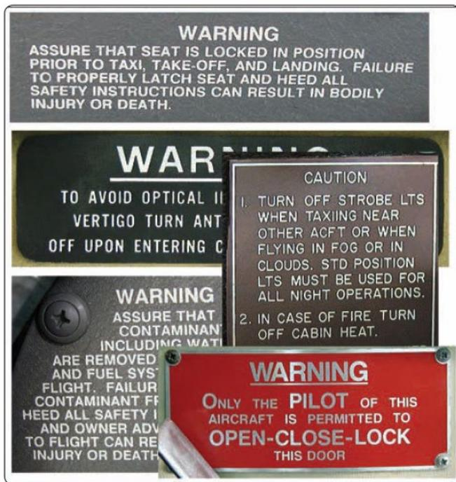
図 9-5. プラカードは、航空機の制限を表すために使用される
