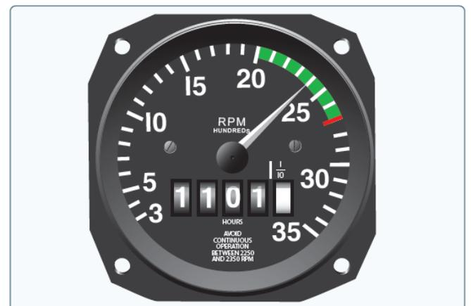
図 9-4. マニホールド圧力計 (上) およびタコメーター (下)
