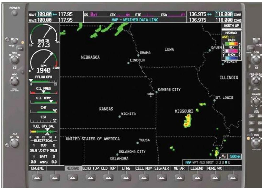
図 13-18. NEXRAD レーダーディスプレイ (500 マイルの範囲)。個々の色のグラデーションは、画面の右上隅にある凡例を介して簡単に識別および解釈できる。凡例ページを表示するLEGENDソフトキーを押すと、追加情報を取得できる。
