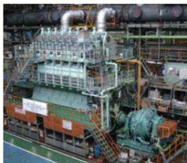
一般的な船のエンジンは、ディーゼル機関です。熱交換率が非常に良いのが特徴です。その他、電気推進機関、タービン機関で動く船なども存在します。
