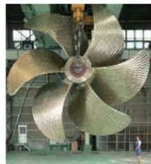
エンジンの出力を推進力に変換するための装置がプロペラです。扇風機が風を起こすように、後方に向けて早い水流を作り、その反力により船は推進します。
