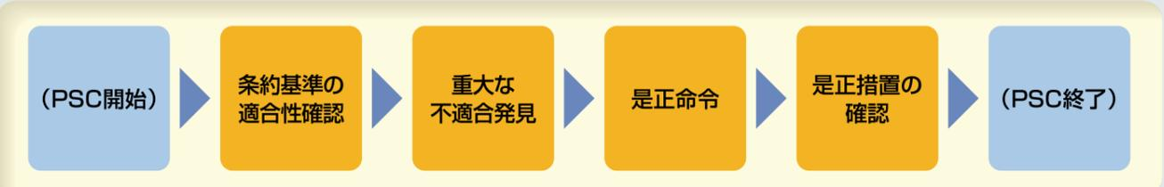
PSCの検査は、条約証書の確認、船体構造の健全性、救命・消防設備、海洋汚染防止設備、船員の資格証明書及び船舶の保安の確保等について国際条約に基づき検査を行います。
