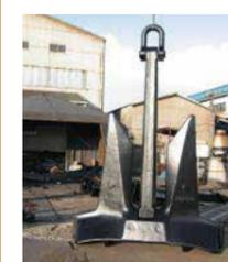
船舶を一定の場所に泊めておくためのものが錨です。錨が海底をかく力と錨鎖が海底に横たわることによる摩擦力により、船舶が風や波浪で流されることを防いでいます。
