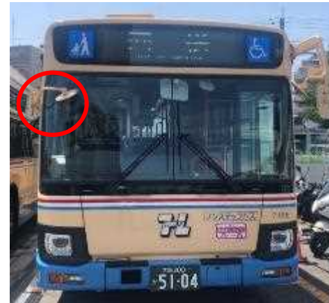
右アンダーミラーの設置
