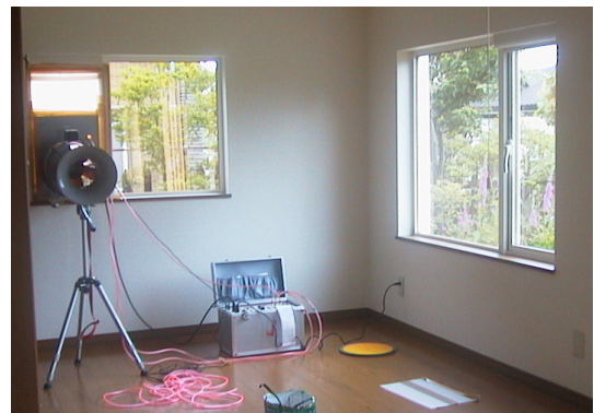
写真 3.2.4 気密測定の様子
