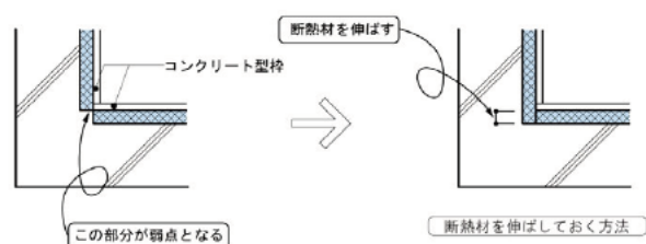
断熱材の施工の注意点
