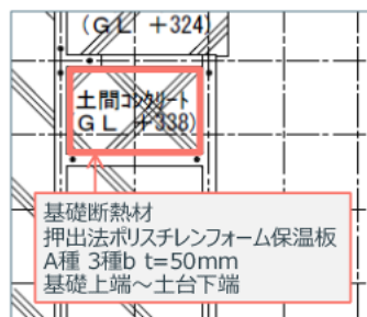
基礎断熱を行う場合の図示の方法
