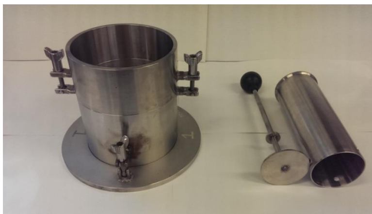
図 1.5.5.1.3.1 – プロクター／ファガベリ装置の例、ハンマーとハンマーのガイド
