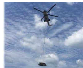
重機をヘリで運搬 (熊本地震の事例)
