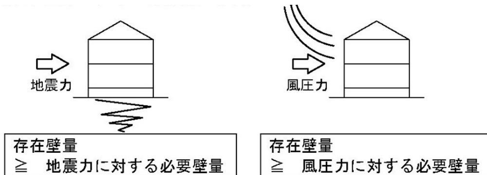
図3-3 地震力と風圧力
