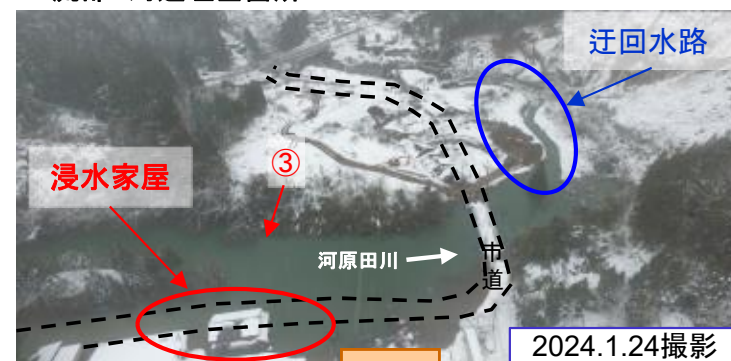
上流部 河道埋塞箇所
