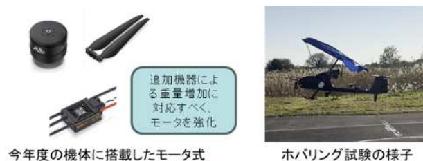
図 5.4.3 ドローンのホバリング試験
