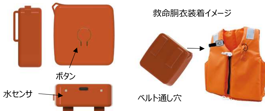
図 5.2.1 エッジデバイス外観と救命胴衣装着イメージ
