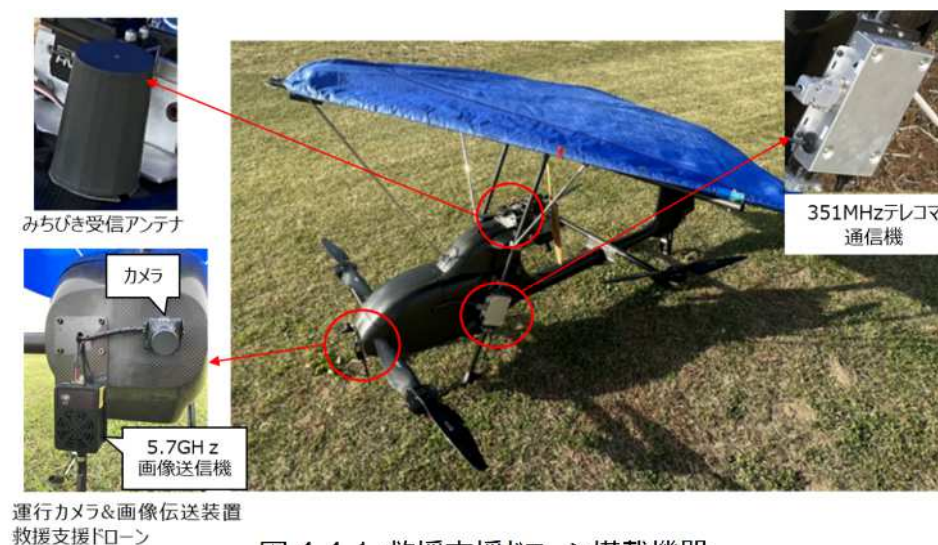
図 4.4.1 救援支援ドローン搭載機器
