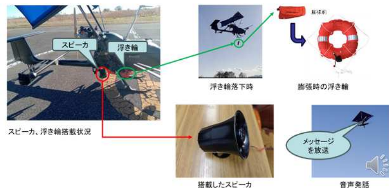
図 5.4.2 浮き輪落下とスピーカによる音声発話試験
