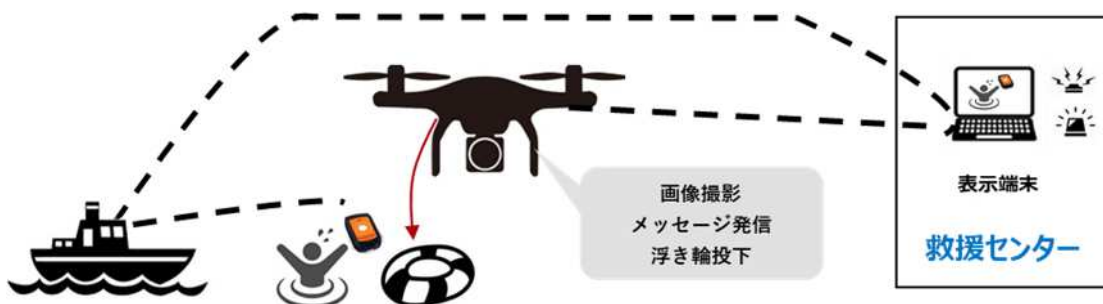
図 3.4.1 救援支援ドローンの機能イメージ（点線は、通信の経路）
