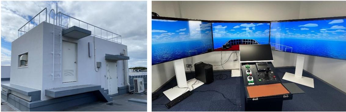
図 3-4 遠隔フリートコントロール室と遠隔監視・遠隔操船用のスタンド
