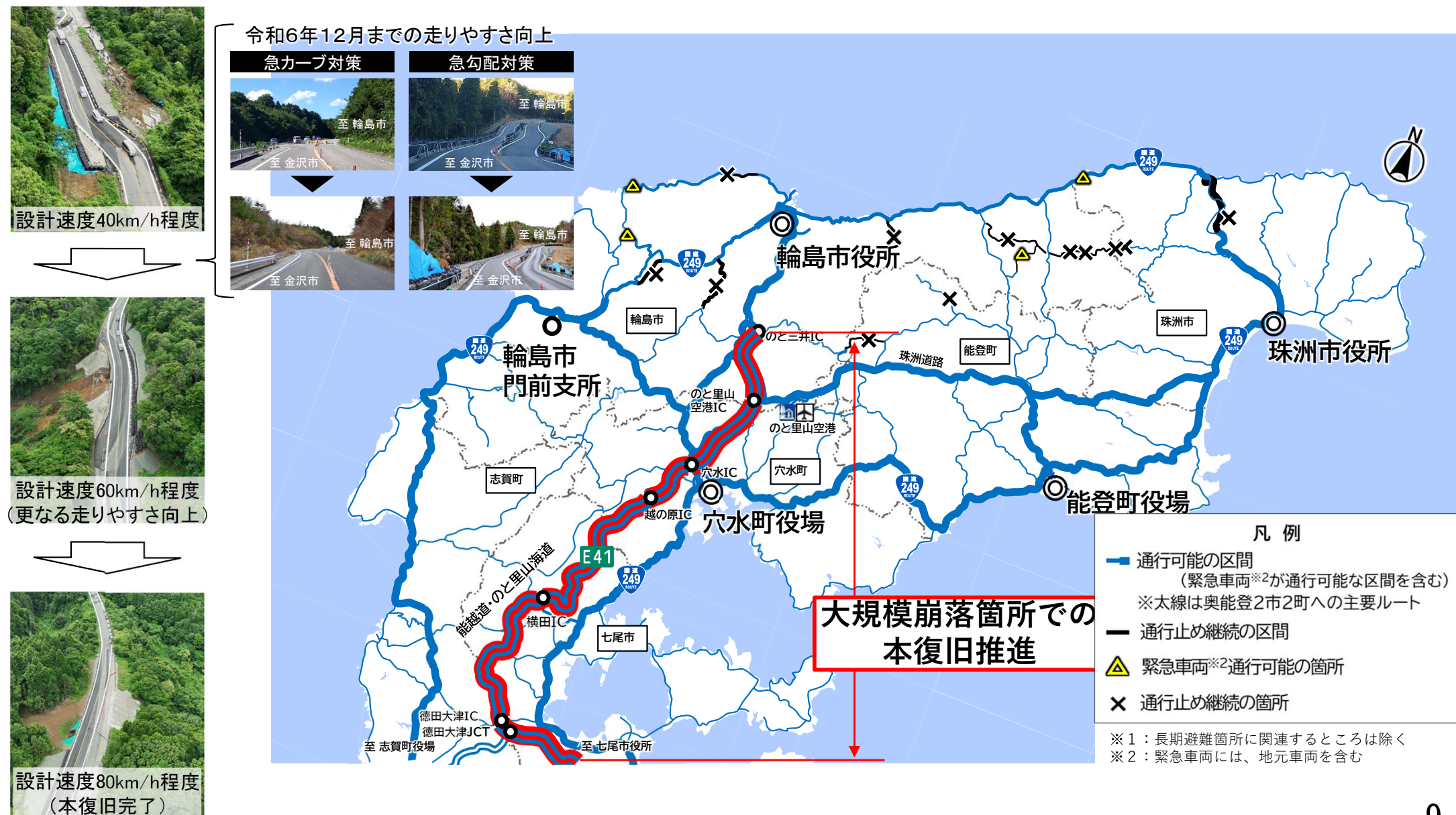
能越道での段階的な復旧イメージ
