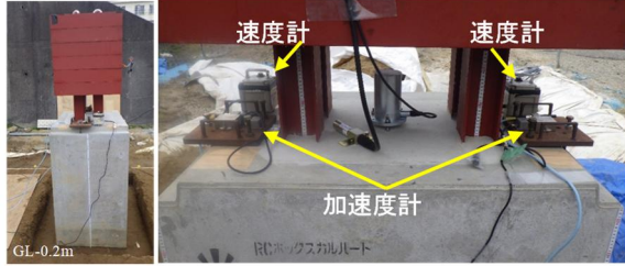
図 4 掘削状況の例とセンサ設置状況（橋脚天端）
