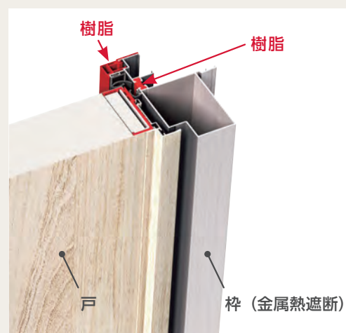
金属製熱遮断構造
