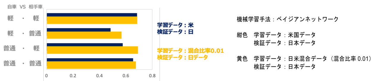
図 5 検証に用いた日本データを自車・相手車の車種で分けた場合の ROC-AUC
