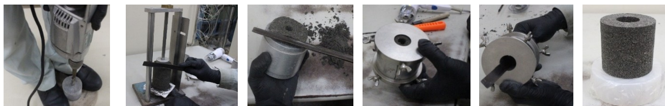
(a) 供試体の穿孔 (b) 外径の整形 (c) 端面の整形 (d) 内径整形準備 (e) 内径の整形 (f) 作製完了 図 14 中空円筒供試体の作成状況
