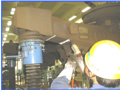
台車枠検査箇所の剥離作業
