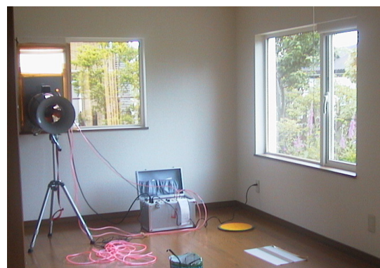
写真 3.2.4 気密測定の様子
