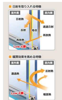
図 3.3.4 Low-E 複層ガラス [日射遮蔽型]
