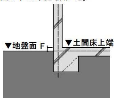
図 1 土間床上端が地盤面と同じか高い場合の土間床上端と地盤面の高さの差
