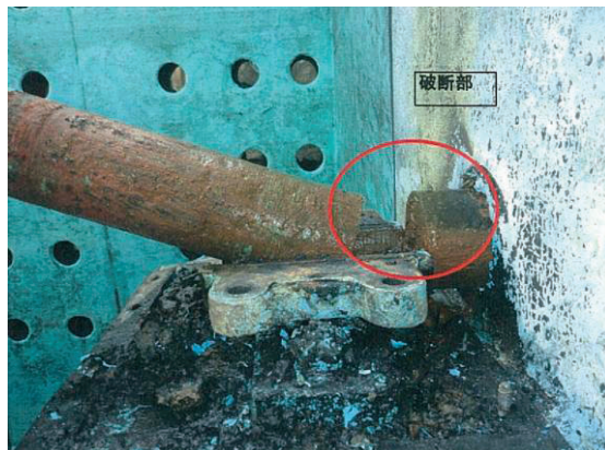
フロキュレータ（パドル式）の主軸が地震動及び地盤変状で折損した
