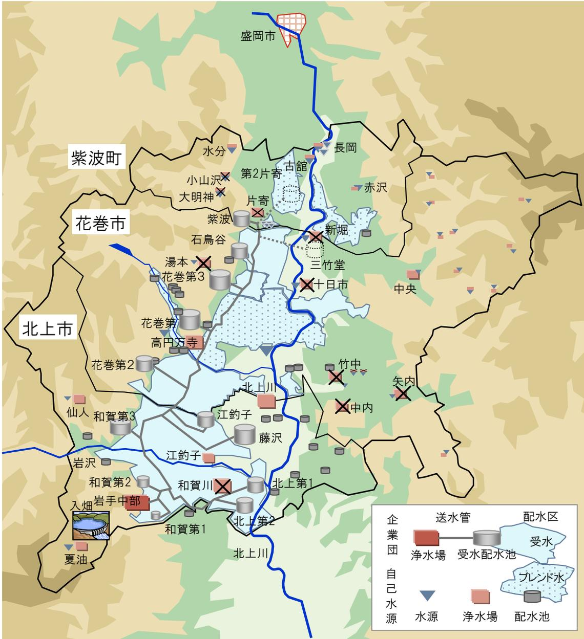
图 1-23 岩手中部広域水道企業団構成市町村 上水道主要施設配置図
