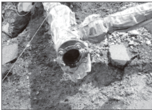
▲あさひ台団地内配水管 (DIPφ100mm) 破損状況 (同左) 写真 4.136 配水管の破損状況
