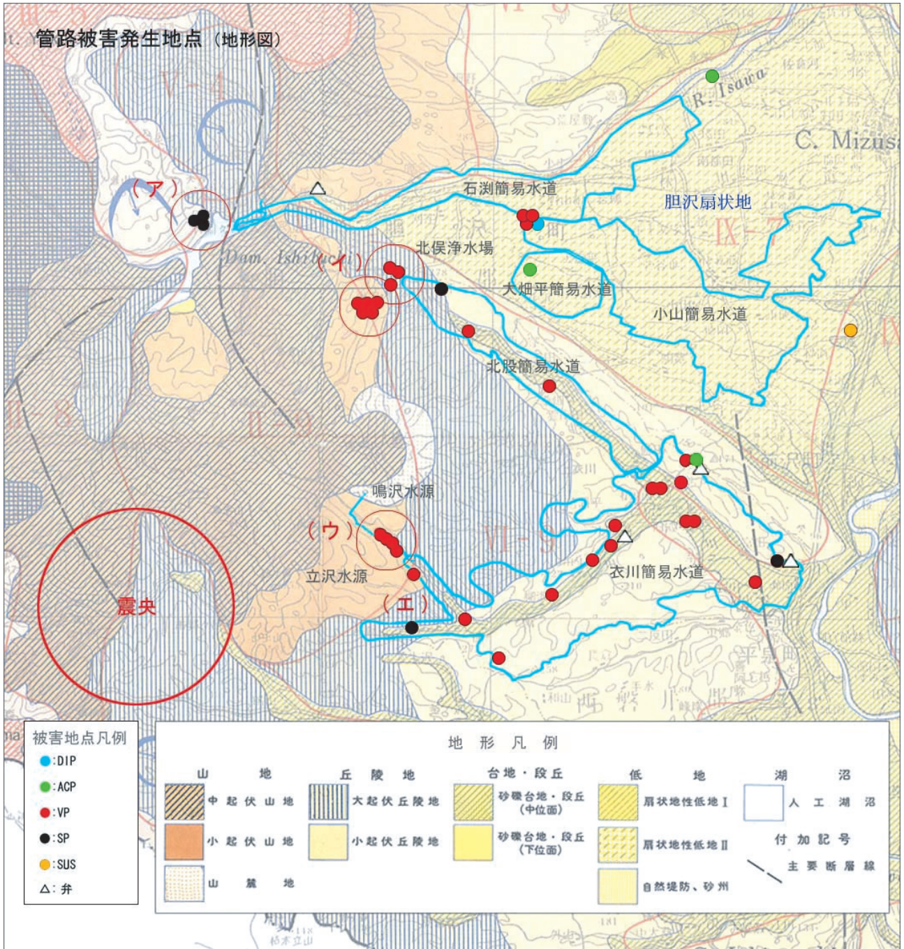
図 4.6 管路被害の発生地点 (簡易水道) (地形分類図)
