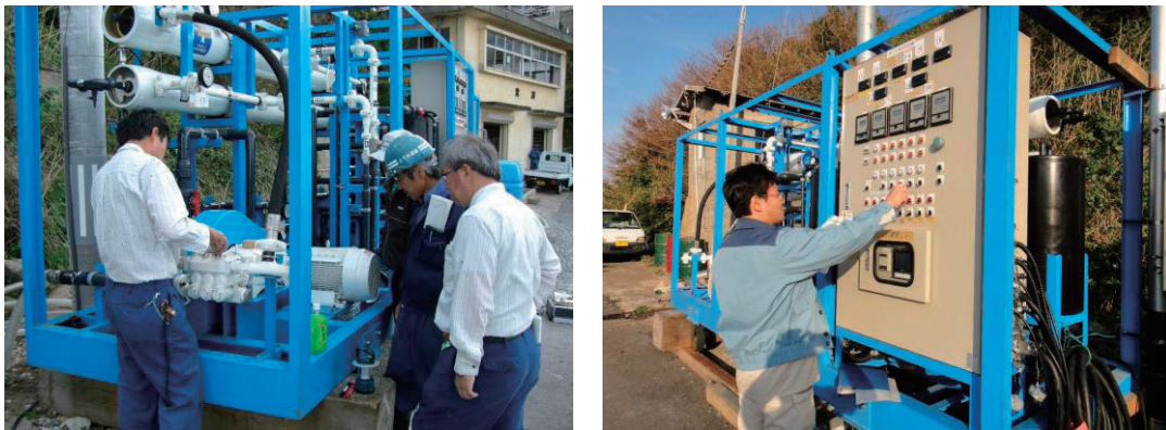
写真 3.1 可搬式海水淡水化装置運転状況
