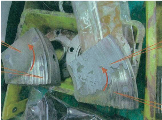
3号取水ポンプ下部スラスト軸受用パッドの 摩耗
