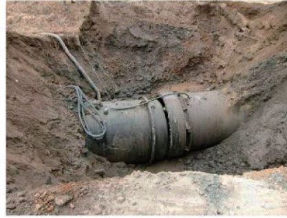
伸縮可撓管抜け落ち2カ所(白石I.C付近 SP φ2400)
