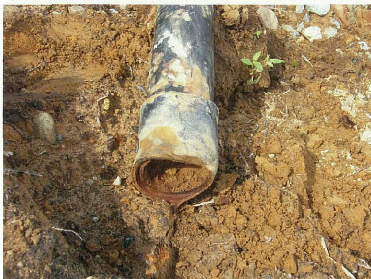
写真 5.19 鋼帯がい装ポリエチレン管 の被害状況（融着継手部破断）
