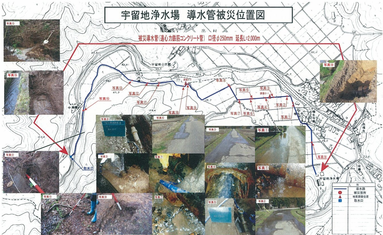
図 4.16 宇留地浄水場への導水管被害
