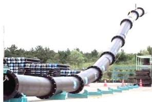
離脱防止機構付き継手(NS形)ダクタイル鉄管の吊上げ試験
