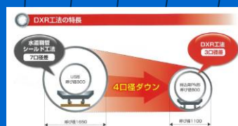
経済的な幹線布設工法 DXR工法
