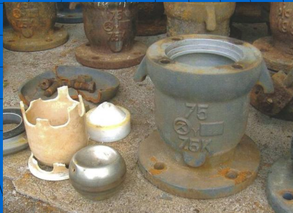
破損した空気弁
