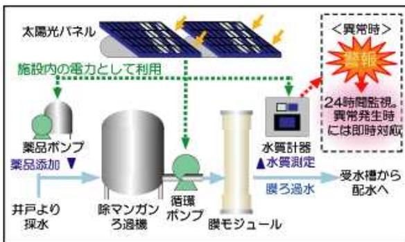
水源を地下水とした膜処理システムにより、安心の水質と、万が一のライフラインの確保も実現可能に致します。
