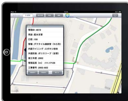
iPadを使用し、スモールワールドで編集したデータを現場で確認できます。紙図面を持ち出さずに済み、片手操作で図面・属性などの必要なデータが閲覧できます。
