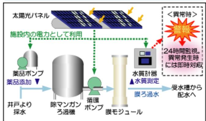
水源を地下水とした膜処理システムにより、安心の水質と、万が一のライフラインの確保も実現可能に致します。
