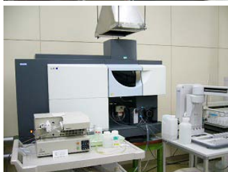
誘導結合プラスマ 発光分析装置
