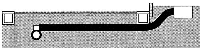
新設 PE 管を配水管のサドル分水栓に接続後水圧試験（1.75Mpa）1 分以上を実施する。
