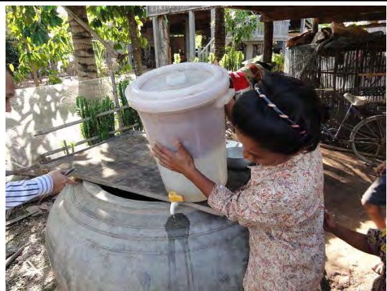
水がめと家庭用セラミック浄水器 (Peam Raing コミューン)
