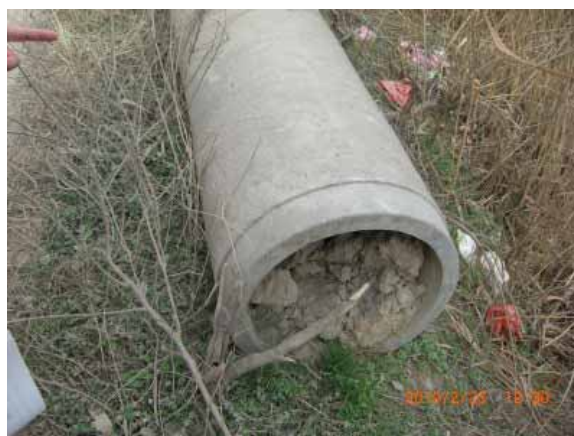
φ300 以上の配水管(ヒューム管)のサンプル
