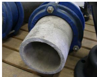
②石綿セメント管
