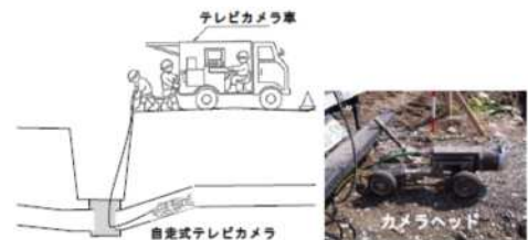
図-1 テレビカメラによる管内調査
