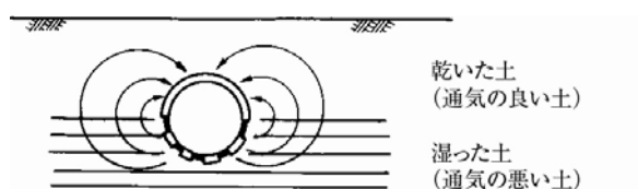
図-7.5.22 湿潤状態によって生じる腐食
