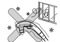
洗浄後は、必ずシャワー開閉ボタンを"閉"の状態にし、水栓の開閉ハンドルで水を止める
