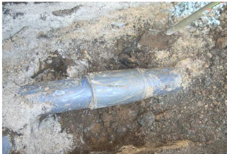
写真 5. 7. 4 VP TS継手φ150 被害状況
