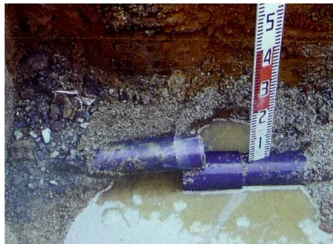
写真 5.4.5 VP  $\phi$  75 継手抜け (益城町寺迫)
