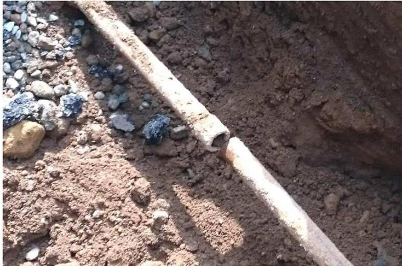
写真 5. 7. 3 SPねじ継手φ40 被害状況
