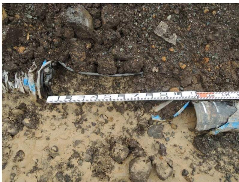
写真 5.7.2 同 DIP A 形  $\phi 200$  抜け被害状況
