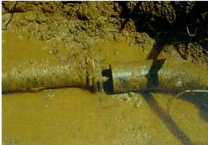
写真 5.4.4 DIP K形  $\phi$  150 継手抜け (益城町水道センター内)
