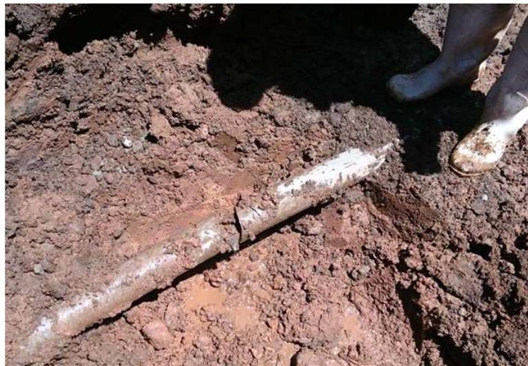
写真 5. 7. 5 VP TS継手 φ75 管体被害状況
