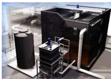
扇浦浄水場に導入するMIEX ® 処理システム
