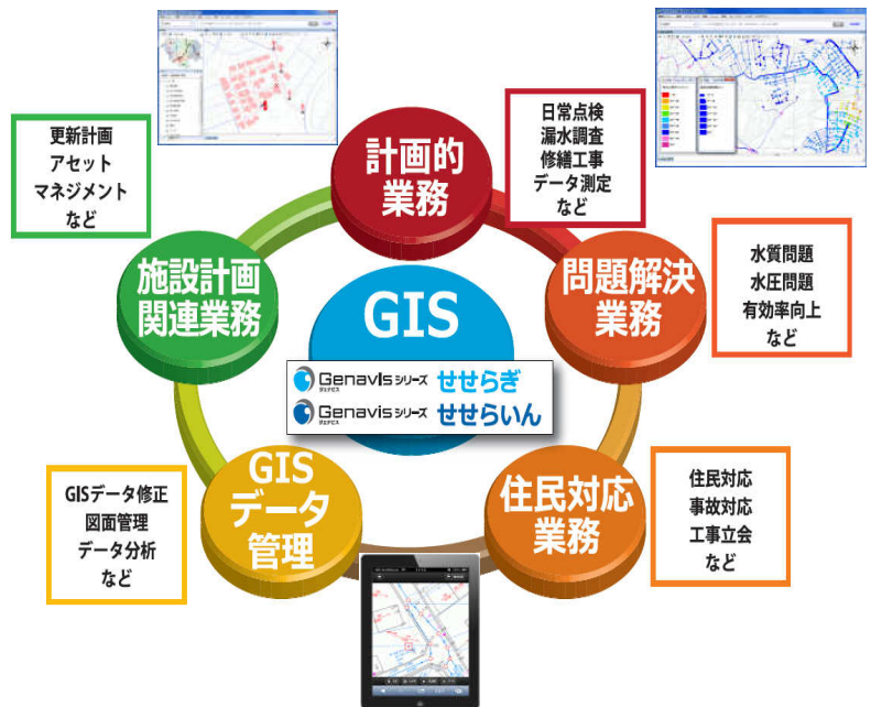
図 Genavis 水道情報システム（せせらぎ）による管路維持管理
