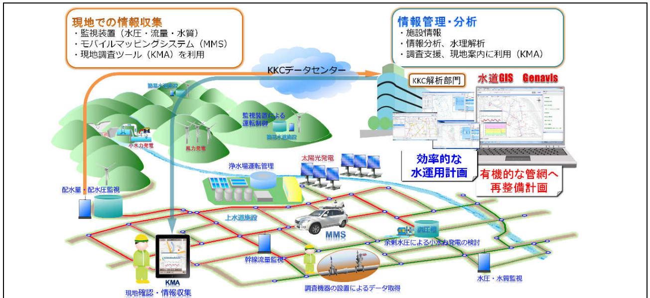
図 クラウドを活用した効率的な維持・管理のイメージ
